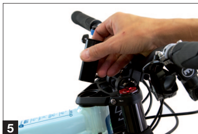
5 Lager und ggf. T-Ring wechseln und Laufflächen fetten.
