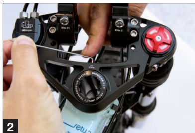
2 Sicherungsschraube mit 1.5mm Inbusschlüssel lösen.
