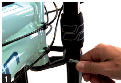
1 Schrauben der unteren Gabelbrücke lösen.
