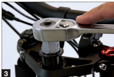
3 Obere F.I.T.-Einheit mit Zahnkranzabzieher herausschrauben.
