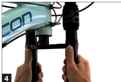
4 Untere Gabelbrücke nach unten abziehen.
