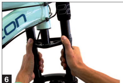
6 Untere Gabelbrücke nach oben schieben.
