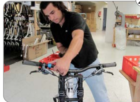
27 Etwas G2/oil auf die Standrohre auftragen.
