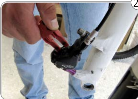
21 Übergelaufenes Öl vom Casting abputzen. Falls nötig, Bremsreiniger verwenden. Schritte 18 – 21 auf anderer Seite wiederholen.
