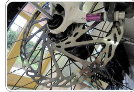
Steckachse mit Inbusschlüssel 5 festziehen.
