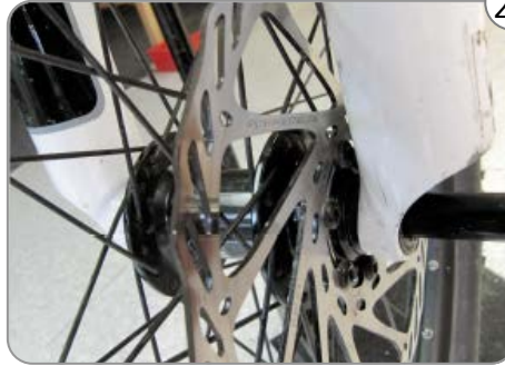
24 Bremsleitung mit Inbusschlüssel 3 befestigen.
