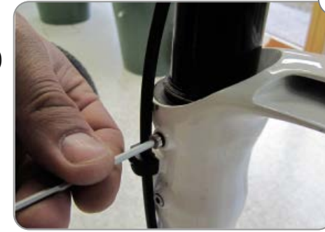
17 Die Bremse mit einem Lappen (vor Öl) schützen.
