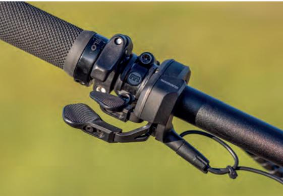
**UMSTÄNDLICH:** Waagrecht platzierte Shimano-Daumenschalthebel zur Motorsteuerung zwingen den Variostütz-Hebel in eine ungünstige Position.
