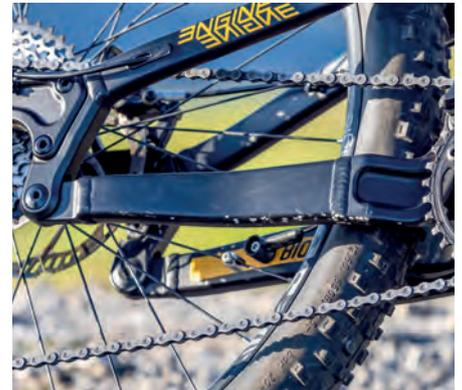
**AUTSCH!** Der Kettenstrebe fehlt ein Schutz, der Lackschäden auf der Unterseite und den Lärm der auf die Strebe schlagenden Kette verhindert.
