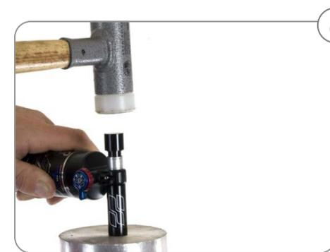
6 Mit BIONICON Bushing-Tool alte Teflonhülse auspressen. Neue Teflonhülse einpressen (Hammer, Schraubstock oder Presse).
