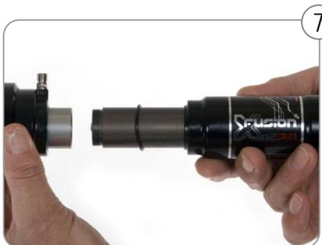
7 Reducer einpressen (an Schraubstock oder Presse).
