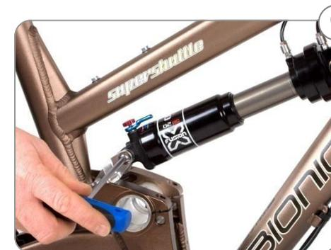
9 Dämpferschrauben fetten und wieder anschrauben (12-15 Nm).
