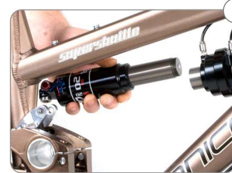
3 Adapter kann am Rad bleiben, Luftverbindung muss nicht geöffnet werden.
