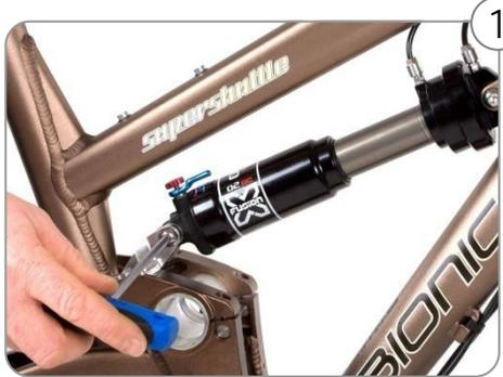
1 Dämpferschrauben lösen.
