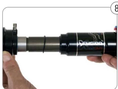
8 Dämpferkolben und Adapterkolben müssen frei drehbar sein
