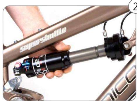
2 Dämpfer vom Adapter mit einem Ruck abschrauben.
