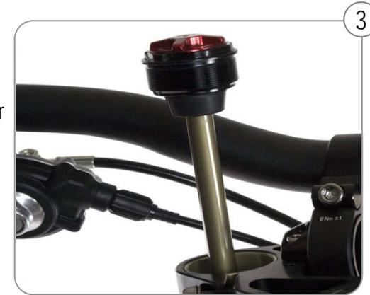
3 Zugstufenkartusche in Tauchrohr einsetzen und einschrauben.
