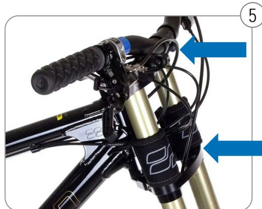
5 Inbus an der Gabelbrücke festschrauben (6-8 Nm).
