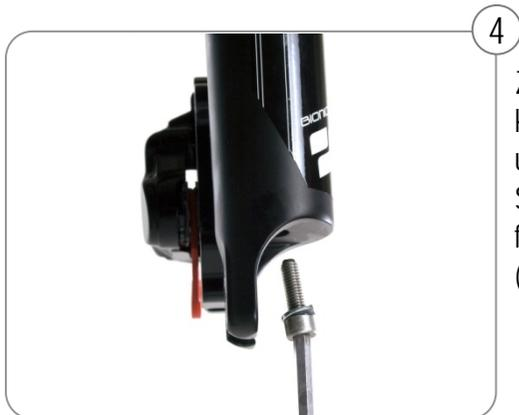
4 Zugstufenkartusche von unten mit Schraube festschrauben, (8 Nm)
