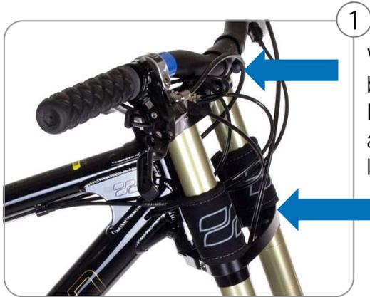
1 Vorderrad ausbauen und Inbusschrauben an Gabelbrücke lösen.
